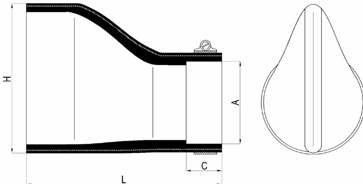
Рис. Обратный клапан тип ROT.
