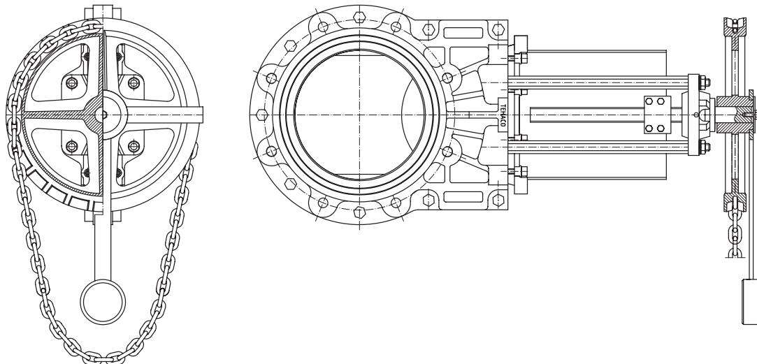
Рис. Задвижка ножевая тип TDO с цепным колесом тип CW.
